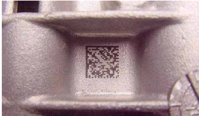
Abbildung 9: Direktkennzeichnung eines Produkts mit GS1 DataMatrix
