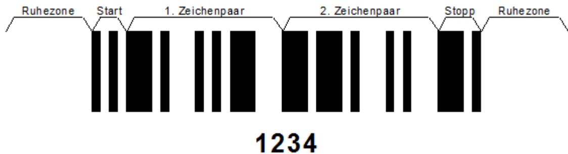
Abbildung 5.3.2.1.2-2. ITF-14 Symbol einschließlich der Ruhezonenn
