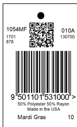
Abbildung 6.3.3.1-3. Beispiel für die Platzierung des 2D Codes im Verhältnis zum linearen Strichcode auf einem Hängeetikett
