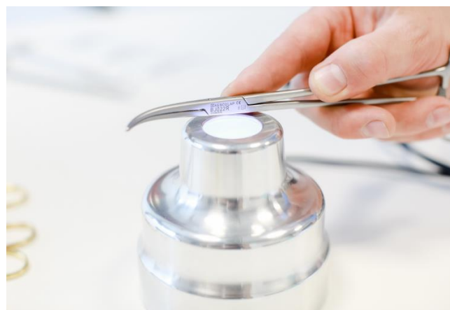
Abbildung 10.18.2-2. Scannen eines GS1 DataMatrix Codes von einem wiederaufbereitbarem Instrument
