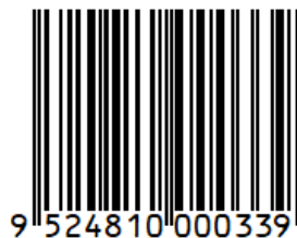
Abbildung 4.14.2-2. Beispiel eines EAN-13 mit Klarschriftzeile
