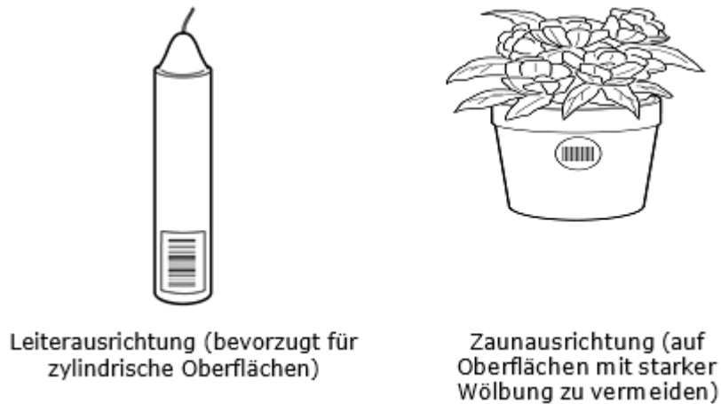
Abbildung 6.2.3.2-1. Barcodeplatzierung auf gewölbten Oberflächen
