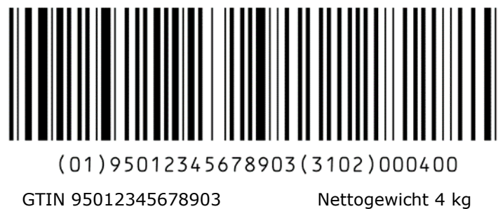
Abbildung 7.8.6.1-2. In einem GS1-128 Symbol verkettete Daten
