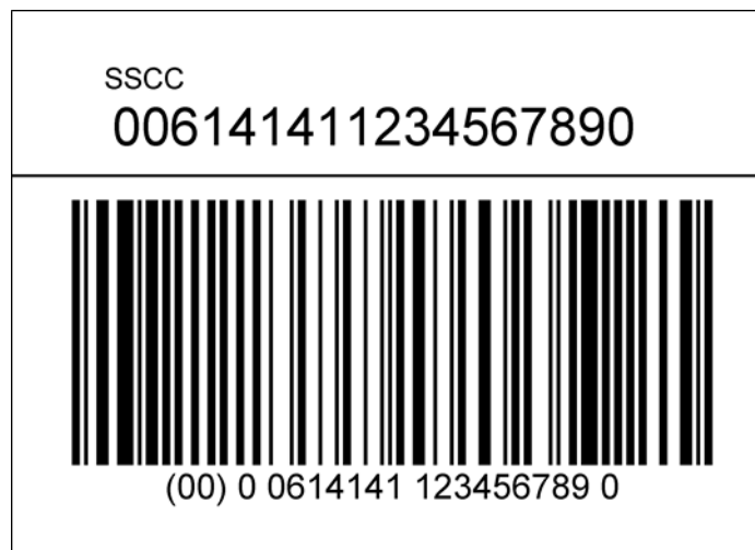
Abbildung 6.6.5-1. Basetikett mit SSCC
