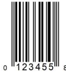
Abbildung 5.2.2.4-1. UPC-E Strichcode (Verschlüsselung von "012345000058" durch Nullunterdrückung)
