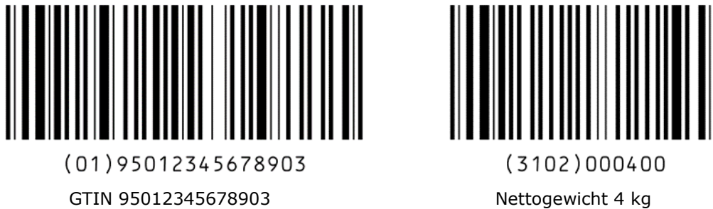
Abbildung 7.8.6.1-1. In zwei GS1-128 Symbolen verschlüsselte Daten
