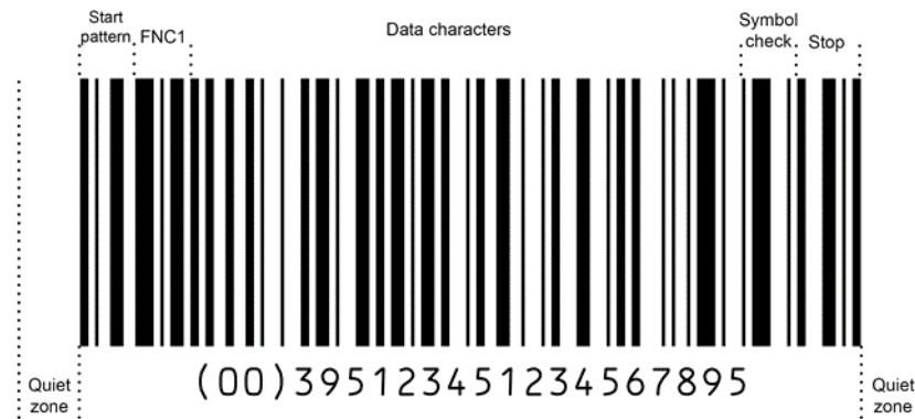
Abbildung 5.4.2-1. Allgemeines Format eines GS1-128 Strichcodes
